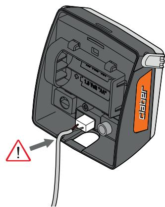
**SENZOR ZA KIŠU RF.** Uklonite unaprijed instalirani zaštitni kratkospojnik s kontakata bez upotrebe alata. Ako se senzor Rain Sensor ne upotrebjava, premosnik mora ostati na mjestu inače programator neće izvršiti automatsko navodnjavanje već samo ručno. Instalirajte RF sučelje senzora za kišu (šifra 8480), provlačeći žičanu antenu u kroz odgovarajuće držače.
